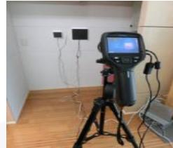
赤外線カメラと、専用解析プログラムにより、実際に建設された住宅の断熱診断と、断熱性能値(Ua値)の検証を実施。
